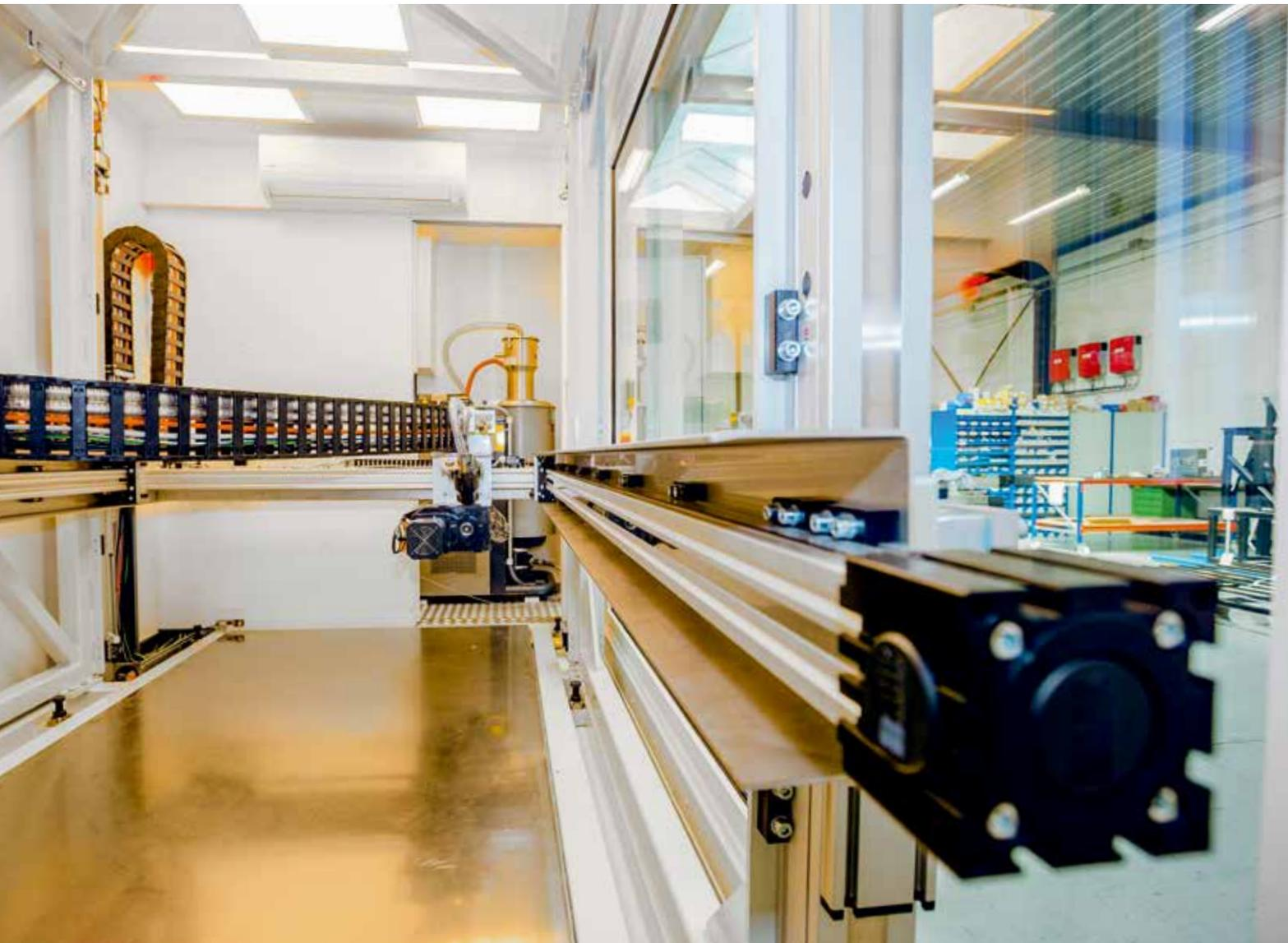
XYZ 龙门架用作 3D 打印机的驱动器：齿形皮带驱动 X 和 Y 轴；另一个计算程序转换所需的 X 和 Y 坐标，以实现正确的齿形皮带驱动控制
